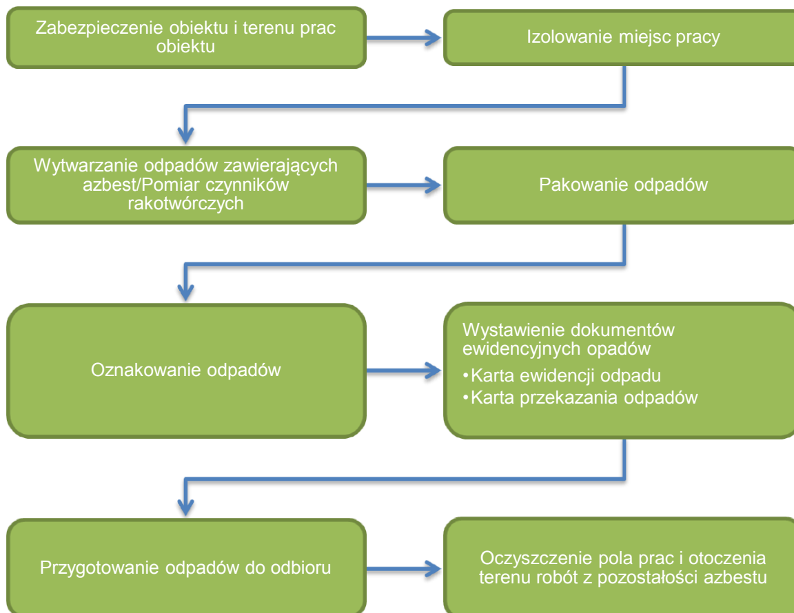
Rysunek 6. Schemat procedury dotyczącej prac polegających na usuwaniu wyrobów zawierających azbest, wytwarzania odpadów niebezpiecznych wraz z oczyszczaniem obiektu/terenu/instalacji.
